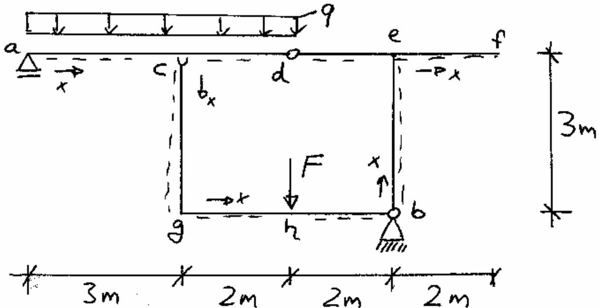
**2. Aufgabe :** Ermitteln Sie für das dargestellte Tragwerk sämtliche Auflagerkräfte und Zustandslinien samt allen wichtigen Ordinaten.
